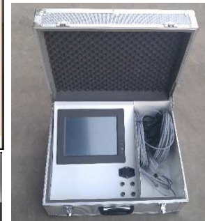
QCS 실시간 주입타수, 주입량 주입압, 주입시간 측정
